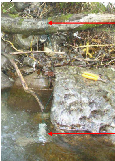
Photo 4 : Exemple de fixation in-situ d'un enregistreur à l'aide d'un fil gainé attaché à une racine.
