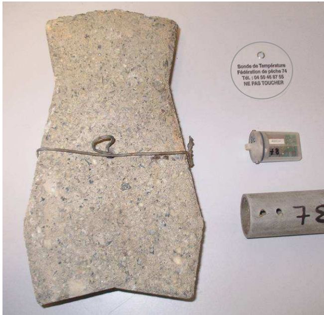
Photo 2 : Eléments constituant le dispositif de protection de l'enregistreur
